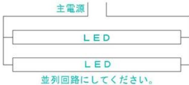
既存の器具を使う場合に、安定器を取り外して、両側に交流（100V~200V）に接続する。
